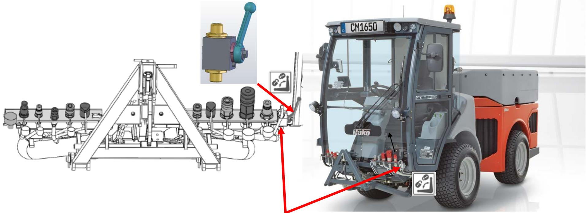
**1. Hydraulikzylinder für die Saugmundmundahebung auf Undichtigkeiten und interne Leckagen prüfen:**
