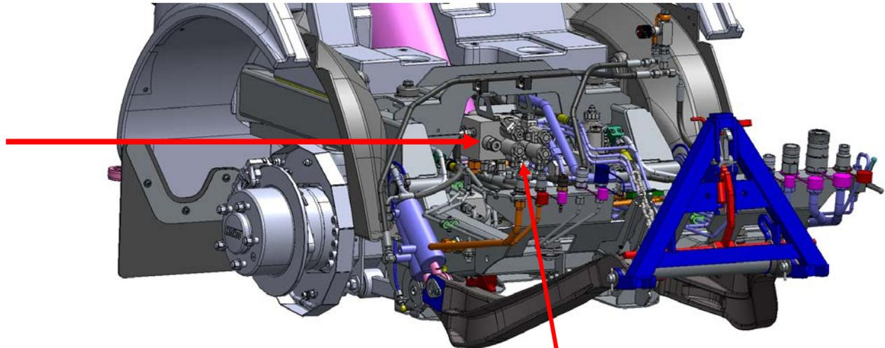
Magnetventil Y13 Frontgeräteträger (FGT) und Saugmund.
