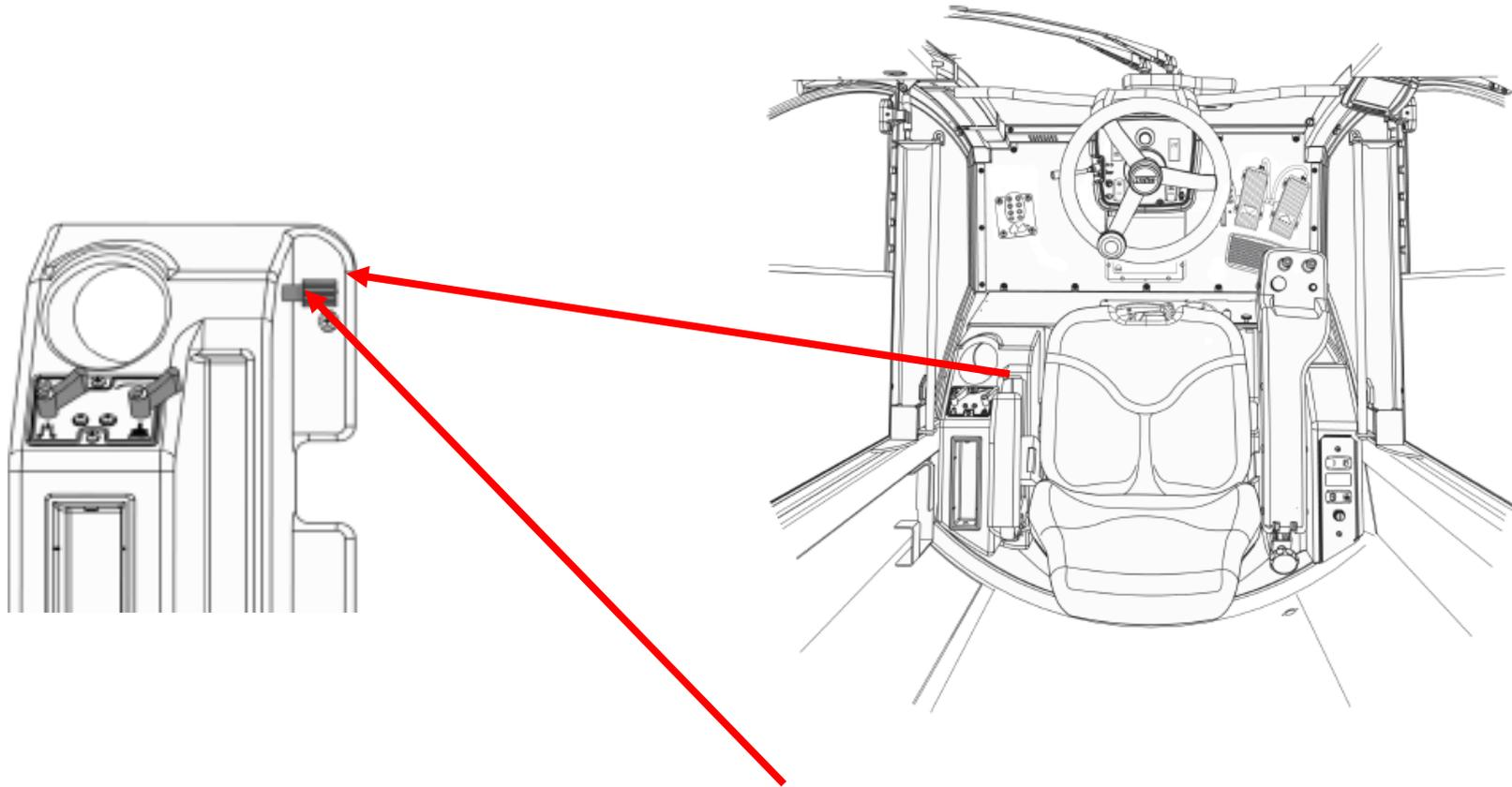
2. Kugelhahn (Absperrhahn) der Saugmundahebung öffnen und die Senkdrossel (Drosselrückschlagventil) für den Frontgerätträger komplett schließen (ganz zudrehen) Senken sich der Saugmund und der Frontgerätträger innerhalb von 12 Stunden eigenständig ab (**kann vom Kunden geprüft werden!**) sind die Hubzylinder auf interne Leckage zu Prüfen.
